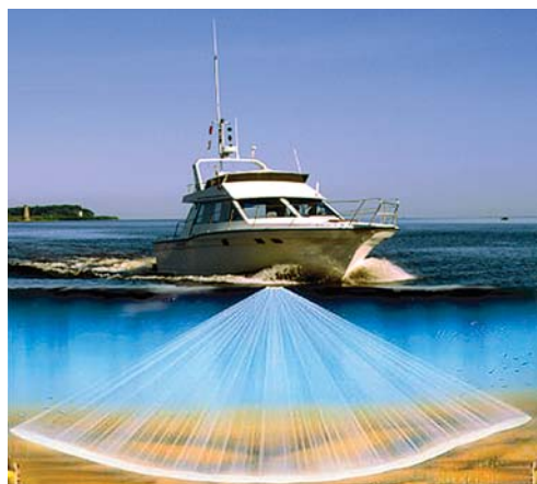
Визуализация технологии площадного обследования гидрографическим катером «Афродита»
